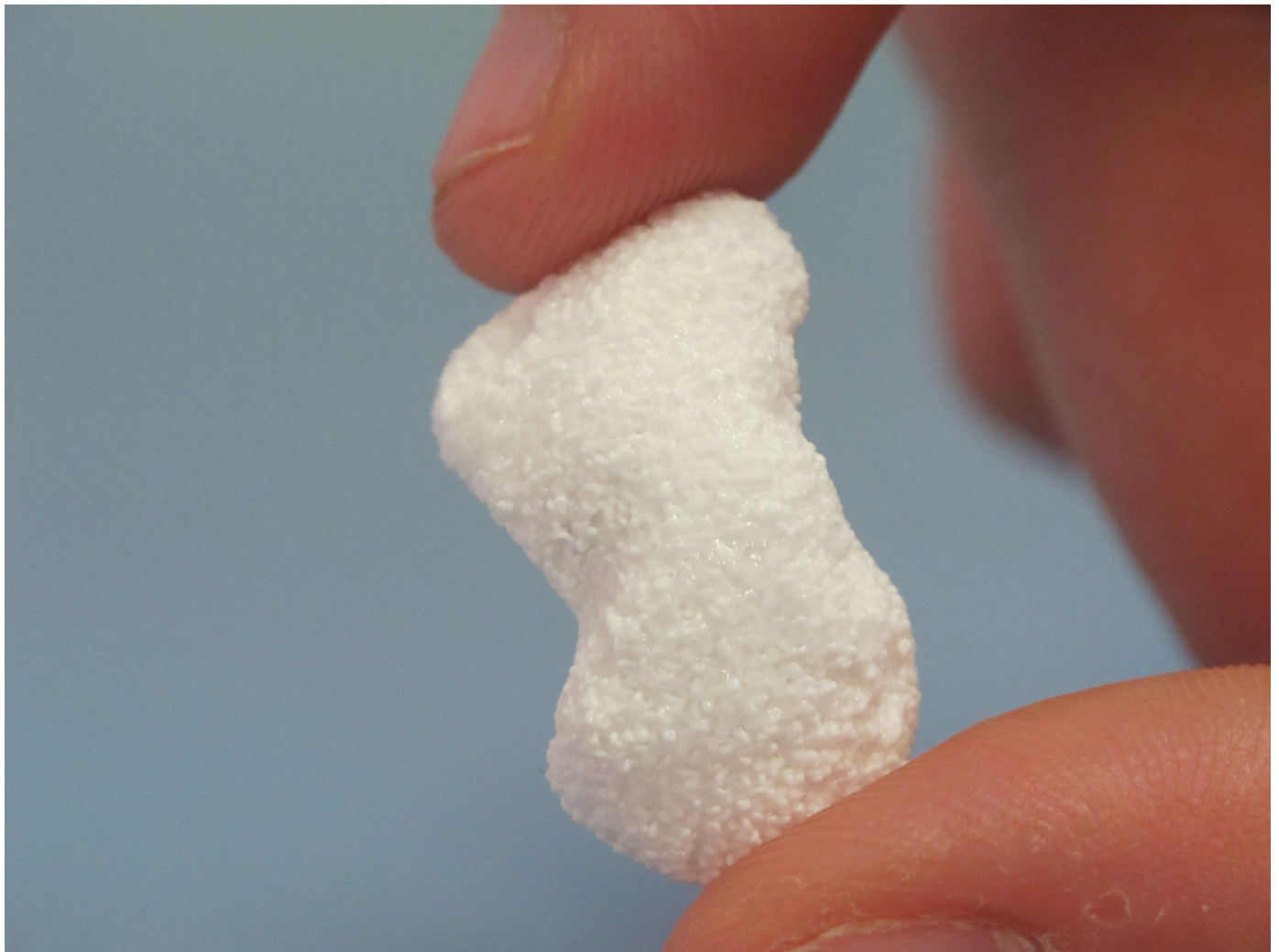
Abb. 2: In der Klinik etablierte, bildgebende Verfahren wie die Computertomographie können genutzt werden, um patientenindividuelle und damit passgenaue Implantate zu drucken. Das dargestellte Kahnbein wurde aus einem CT-Datensatz einer Hand gefiltert und mit Hilfe eines Kalziumphosphatzementes gedruckt. (Quelle: Zentrum für Translationale Knochen-, Gelenk- und Weichgewebeforschung, Universitätsklinikum Carl Gustav Carus und Medizinische Fakultät der Technischen Universität Dresden)
