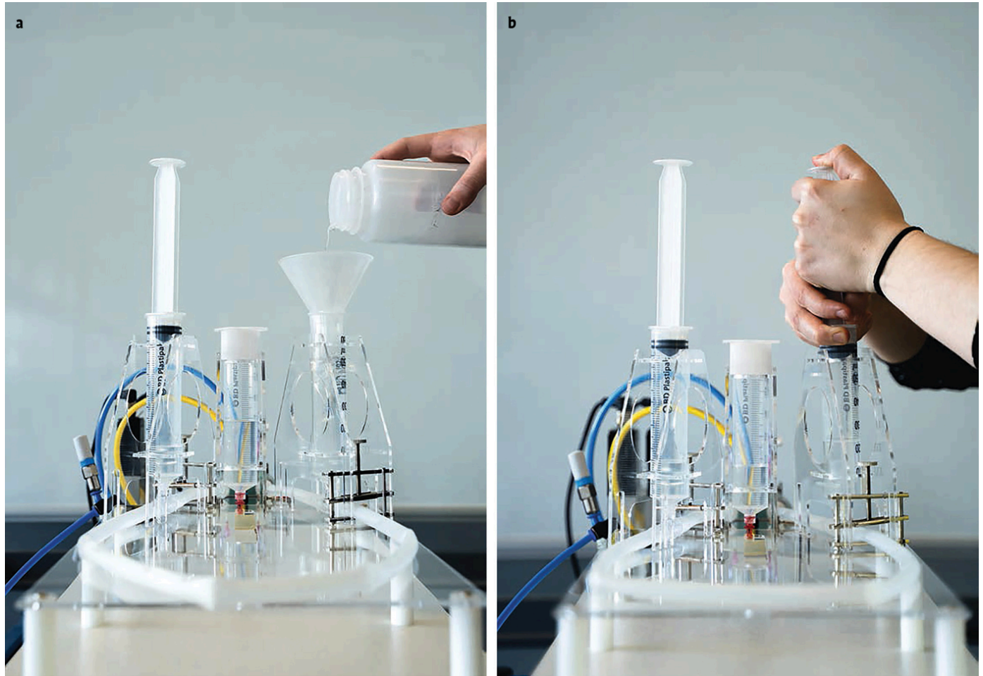
Abb. 7a,b: Um mehr über den Blutkreislauf von Frühgeborenen zu erfahren, simuliert man ihn mit einer Pumpe und Schläuchen
