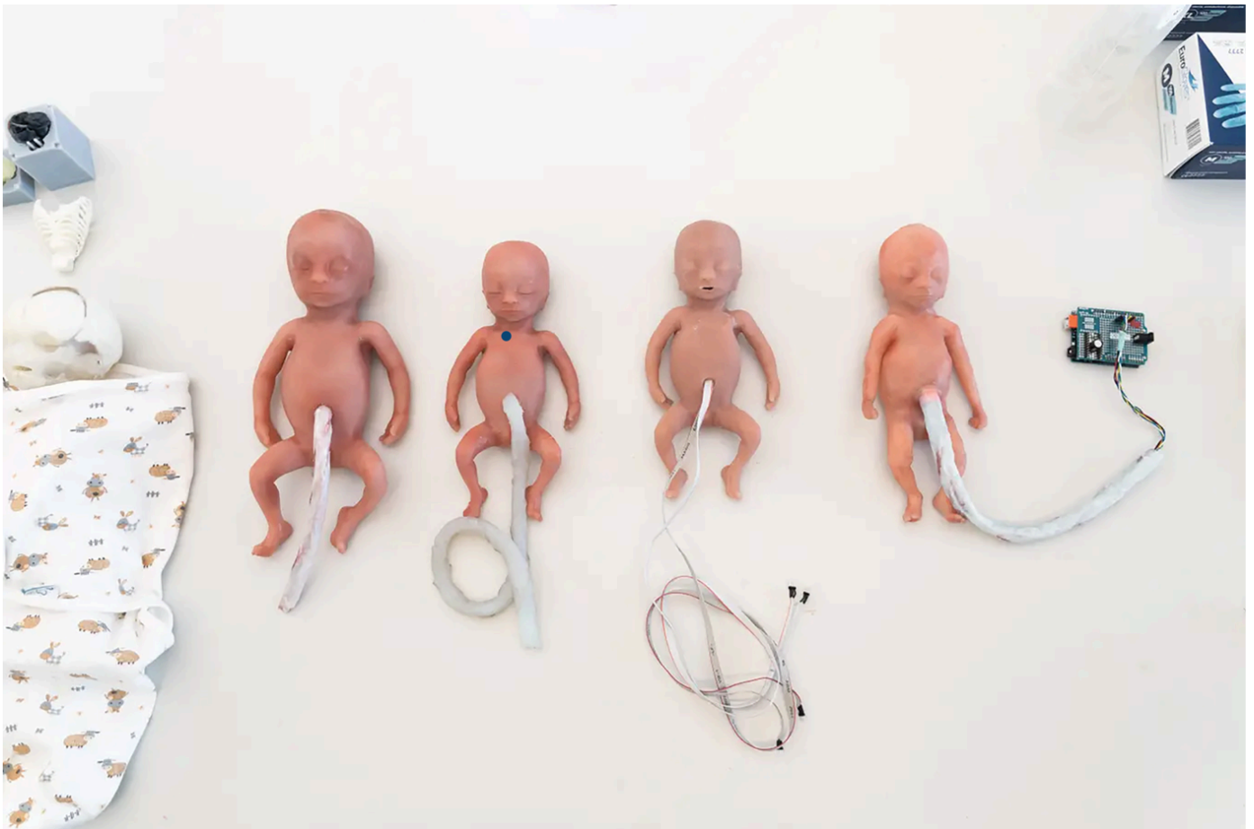
Abb. 6: Silikonföten: Mittels Puppen wird die Geburt unter Wasser und der Aufenthalt im Fruchtwasser getestet und verfeinert.
