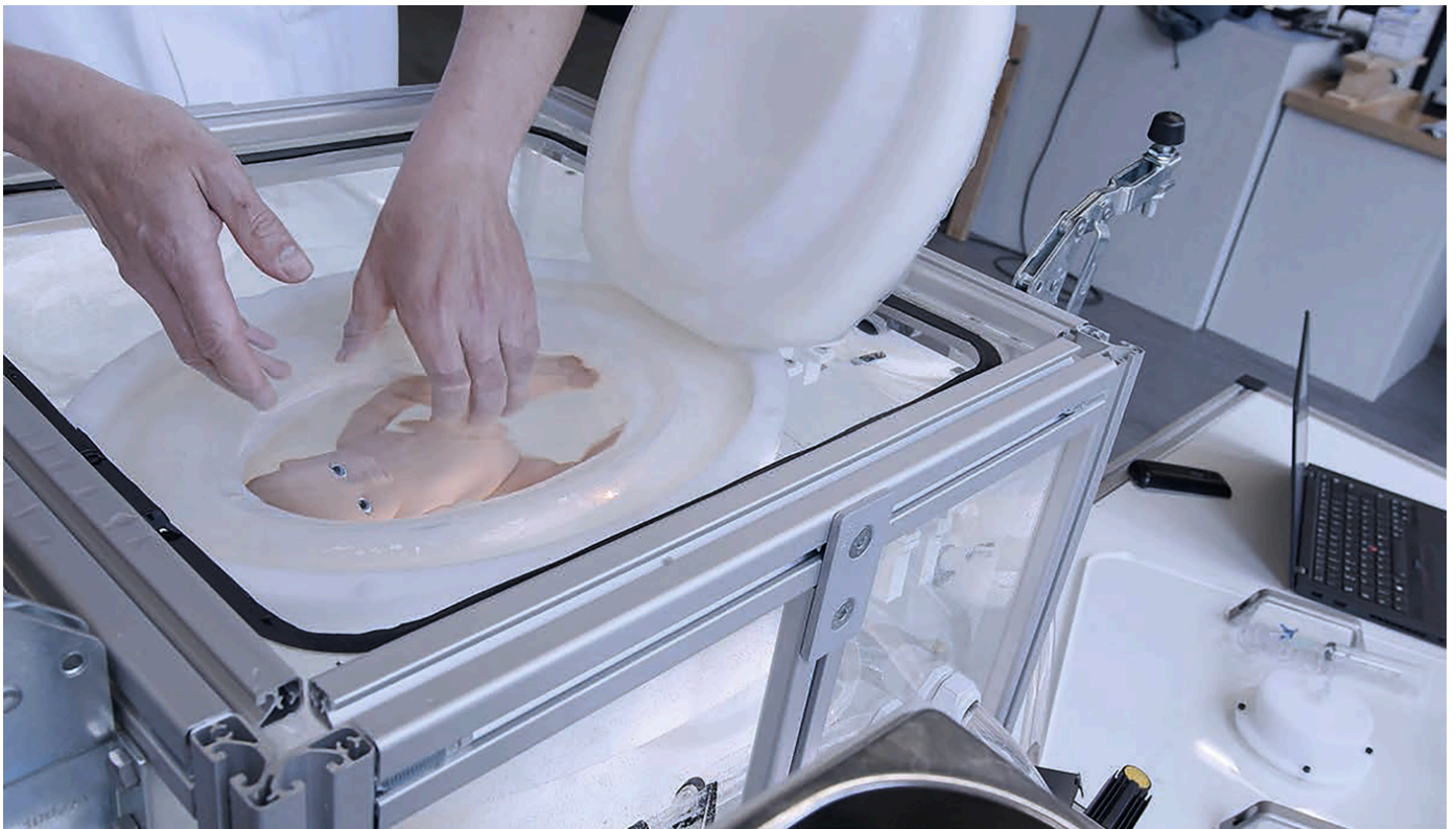
Abb. 2: Prototyp der flüssigkeitsgefüllten Kammer („künstliche Gebärmutter“) an der Rheinisch-Westfälischen Technischen Hochschule: Ein Frühchen soll maximal vier Wochen darin verbringen. Eine künstliche Plazenta versorgt es mit Sauerstoff und Nahrung.
