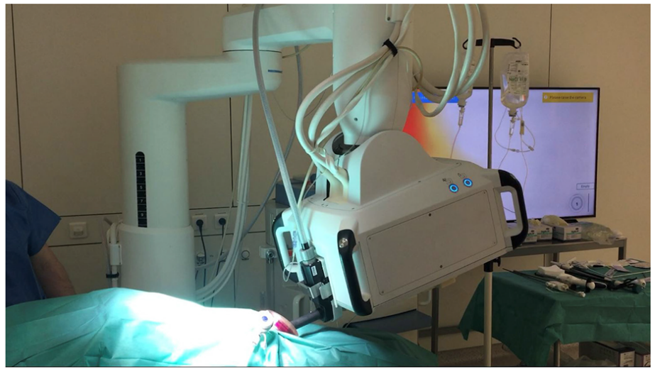
Abb. 6: Das Single-Port Device Enos™ verfügt über multiartikulierende Instrumente, die über einen 25-mm-Port eingeführt werden sowie über ein offenes Konsolendesign mit Controllern und Fußtritten.
